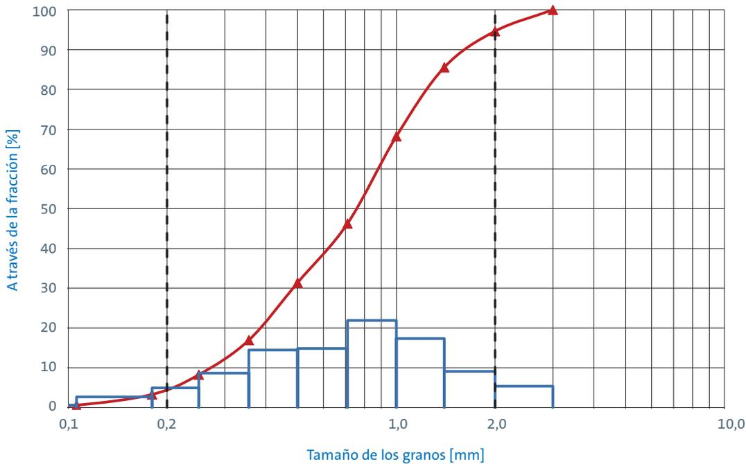
Método de análisis: De acuerdo con la norma DIN EN 12902 usando tamizado húmedo
